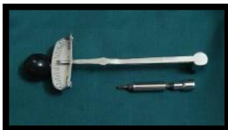
**Fig. 8: Torque Meter**
